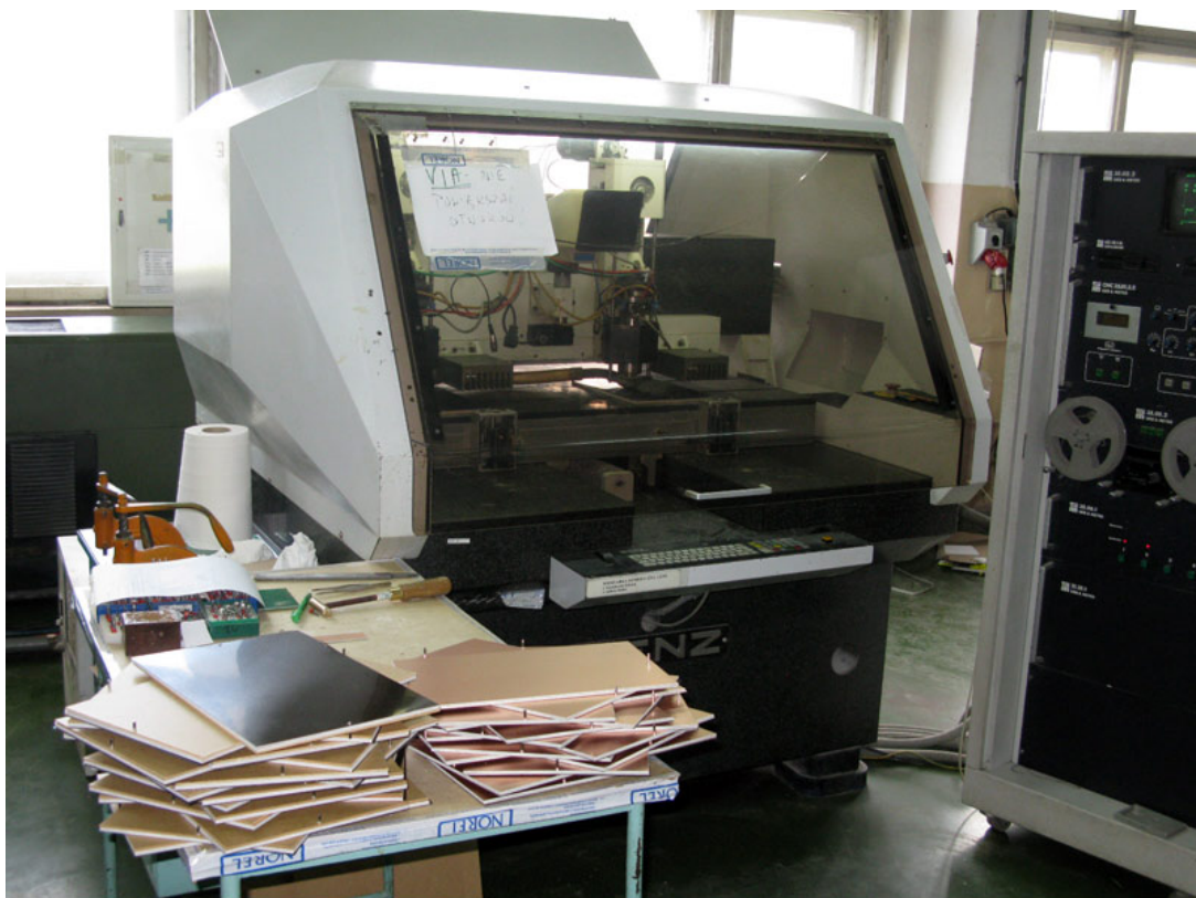
Wiercenie otworów w przygotowanych pakietach
