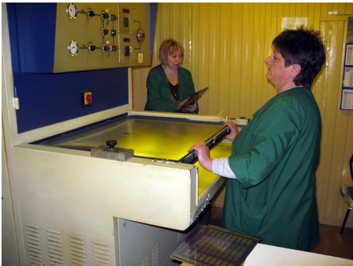
Przenoszenie rysunku ścieżek na laminat przez naświetlanie
