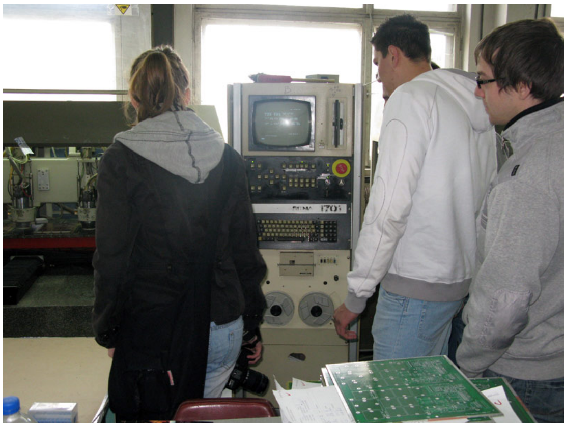
Maszyna numeryczna wierci otwory w laminacie
