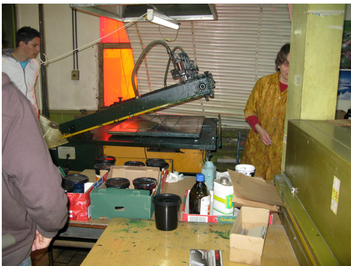
Nanoszenie opisu na gotową płytkę
