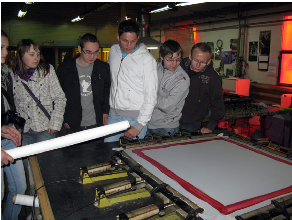
Proces przygotowania sita do nanoszenia opisu na PCB
